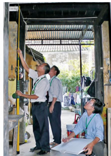
メジャーボールで部材の高さを測る
