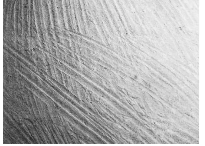
কাঠের পাত ব্যবহার করে পাত্রের পৃষ্ঠ মসৃণকরণ
