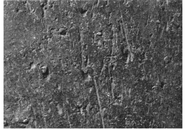
ক্ষুস্তির মত টুল ব্যবহার করে পাত্রের পৃষ্ঠ চাঁছা
