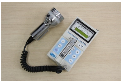
資料に付着した放射性物質の放射線量を計測する GM 式サーベイメーター
