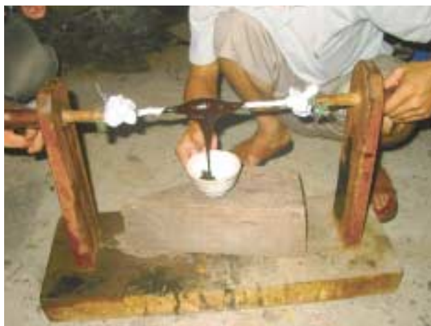
④伝統的な漆の精製方法 Traditional method filling lacquer
