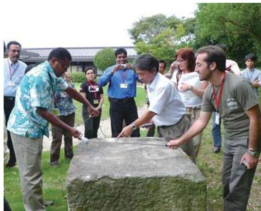
石材表面の剥離箇所を検出する試験
