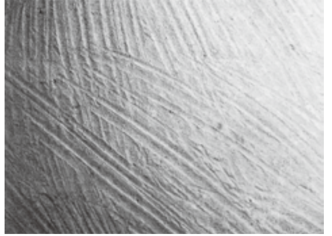
কাঠের পাত ব্যবহার করে পাত্রের পৃষ্ঠ মসৃণকরণ
