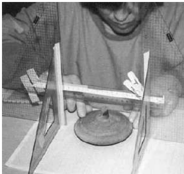
1 ວັດແທກເສັ້ນລັດສະໝີຂອງເຄື່ອງປັ້ນດິນເຜົາ ວາງເທິງເຄື່ອງປັ້ນດິນເຜົາໃສ່ເທິງເຈ້ຍຕາຕະລາງ
